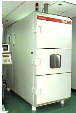
Thermal Shock Chamber Model: Votsch VT7012
